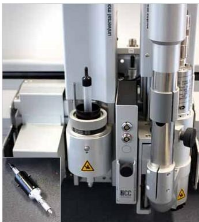
Narzędzie RBT zamontowane w module uniwersalnym cuttera serii G3.
